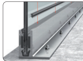
6. oberes Verglasungsprofil einsetzen
